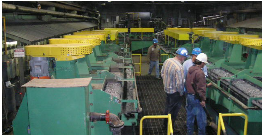
Instalación de Celdas de Flotación Para Aumentar la Capacidad de Producción de Concentrado de Zinc. Proyecto Ejecutado en una Planta de Beneficio en USA.
