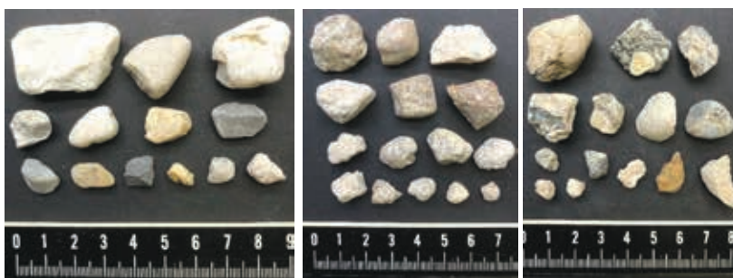
Voorbeeld van korrels in fractie 4-22 mm: grind (links), SmartCrusher/SCP (midden) en ADR/GBN (rechts)
