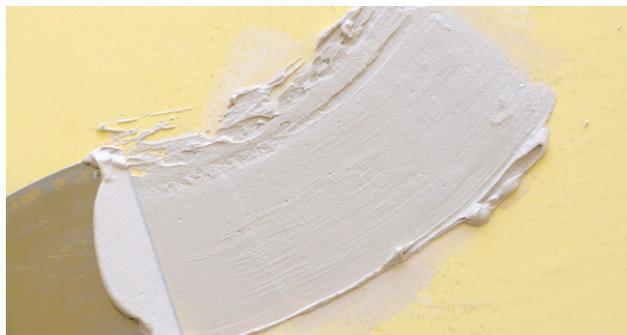
La peinture est appliquée sur du placo sur lequel on a préalablement mis un enduit. Après séchage, on évalue visuellement et mesure au brillancemètre le brillance de la peinture sur placo en direct et sur placo avec enduit. *The painting is applied on a placo on which a coating has previously been applied. After drying, the brightness of the paint on the placo is measured visually and measured at the glossmeter.*
